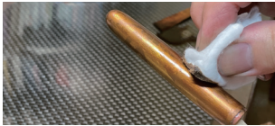
⑤粉固め 粉に漆を浸み込ませ固める
