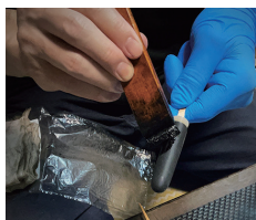
①下塗り(2回) 素地に黒のすぐろめ漆※を塗り、この後の漆の工程のベースをつくる。
