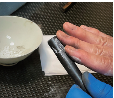
⑧-1磨き (惺-sei-のみ) コンパウンドで艶を出し、まだら模様を浮き立たせる。
