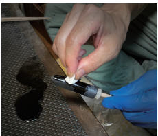
⑦拭き漆 漆を浸み込ませ、箔を定着させるため拭き漆を行う。
