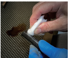
⑧-2拭き漆(3回) (影-ei-のみ) 漆を浸み込ませ、漆の質感を出す。
