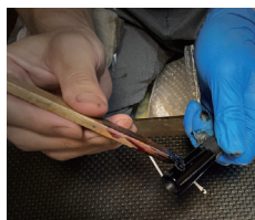
③中塗り(2回) 滑らかに形を成型した後、漆を塗る。
