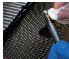
⑤拭き漆 箔を定着させるため拭き漆を行う。
