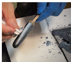
④箔(2層) 漆を薄く塗り、漆が乾く前に黒銀箔の表裏を使い分け表情を出しながら貼りつける。
