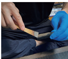
②筋作り(3回) 漆と砥の粉で出来た下地材をヘラで形作る。1層ごとに研いで整える。
